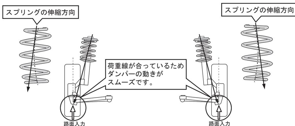
※特殊形状のスプリングのため、取り付ける方向性があります。裏面の「取付上の注意事項」に従って正しく取り付けてください。
